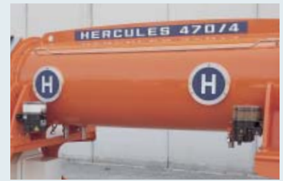
Centraline elettroniche di lubrificazione centralizzata dei cuscinetti di banco e del raschiafango. Electronic control boxes for centralised lubrication of main bearings and sludge scraper. Pilote électronique des centrales de graissage des roulements principaux et du racleur.
