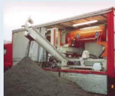
Unità mobile disidratazione fanghi Sludge drying mobile unit Unité mobile pour déshydratation de boues
